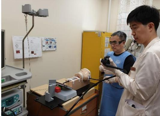
그림: (1) Home-made EndoGEL docking station, (2) Docking station을 Koken simulator에 장착한 후 EndoGEL을 얹은 모습, (3) 시술 장면 근접 촬영, (4) EndoGEL ESD hands-on training 장면
