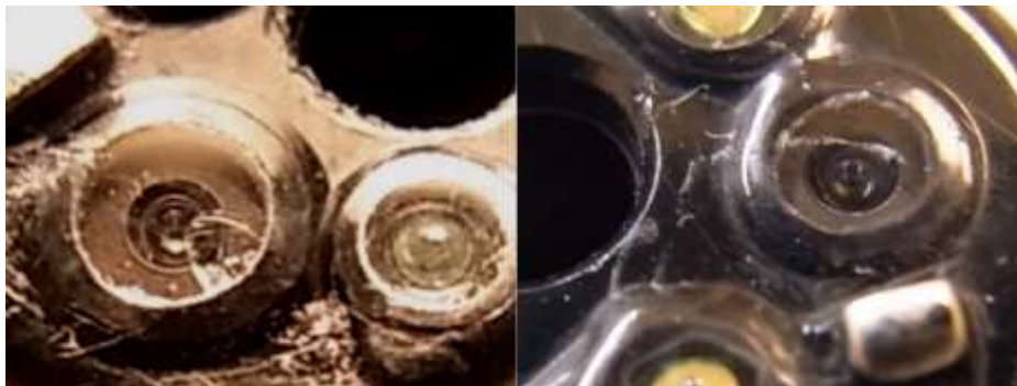
그림: 대물 렌즈와 광원 렌즈에 크랙이 발생한 내시경. 이 정도 손상이면 화질이 나빠져 검사를 할 수 없습니다.
