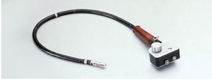
사진 8. 이때 개발한 내시경 사진. 현재의 내시경과 유사하나 카메라가 달려 있는 점이 특이하다.
